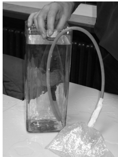
Anschließende Volumenmessung in einer Wasserwanne
