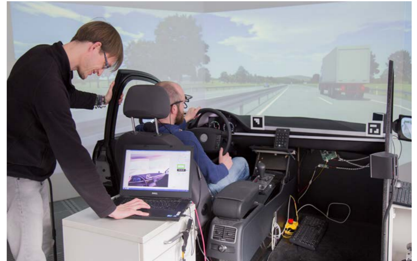
In einem Fahrsimulator erproben Wissenschaftler von Universität und OFFIS Assistenzfunktionen für selbstfahrende Autos.
