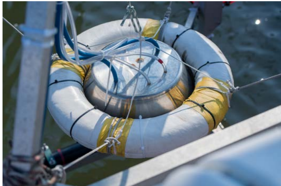
Das Herz der Messboje: Ein Sensor misst, wie sich der CO 2 -Gehalt ändert.
