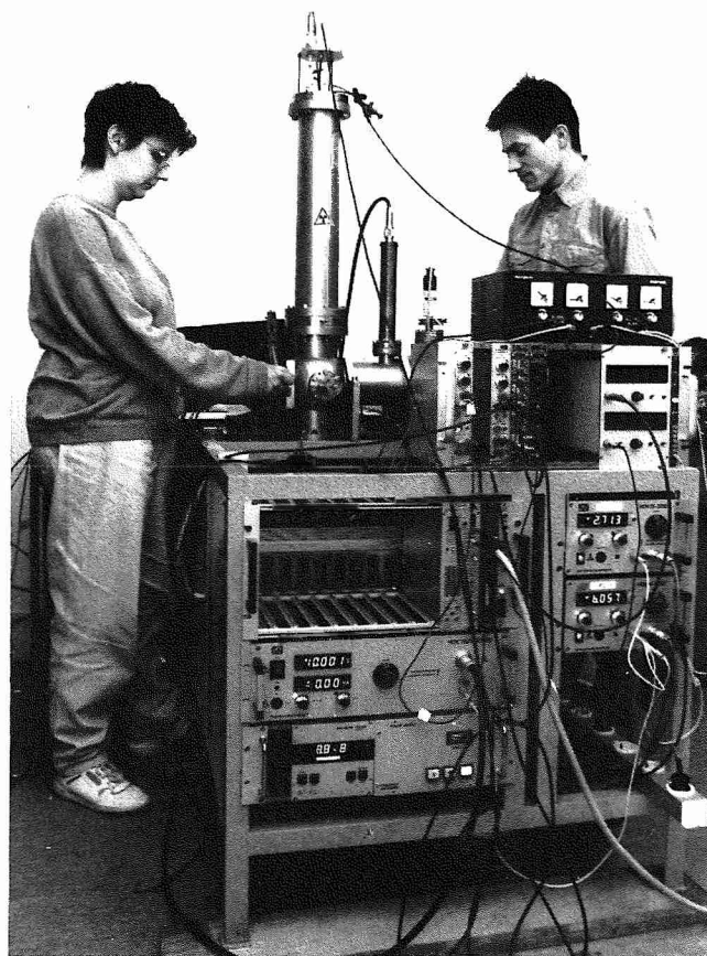
Probeneinführung am PDMS-Spektrometer
