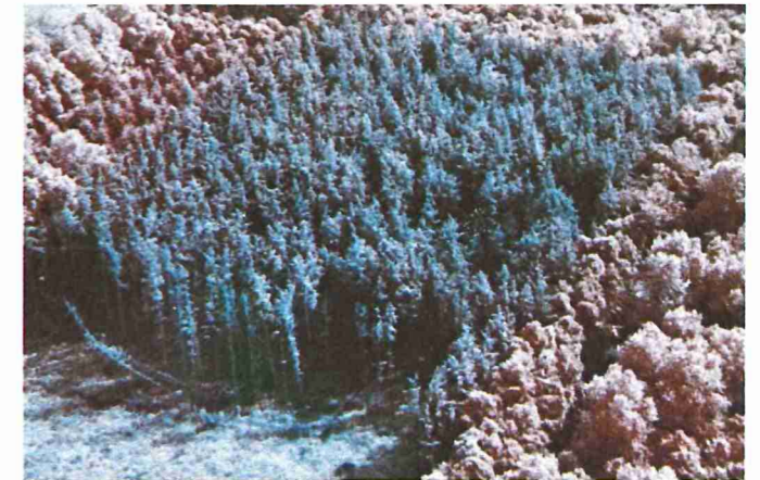
Infrarotaufnahme von geschädigtem Wald: die Blau-grün- bis Schwarzfärbung (höchste Stufe) zeigt den Grad der Schädigungen an. Die Rotfärbung bedeutet: die Bäume sind gesund.
