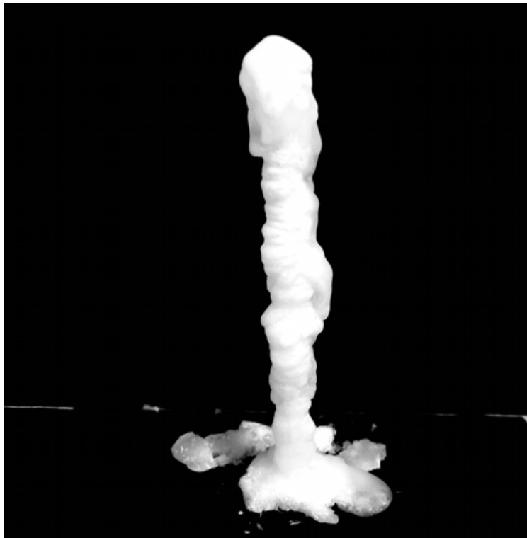
Abb. 1: Stalakmitähnliche Säule aus einer übersättigten Lösung gegossen.
