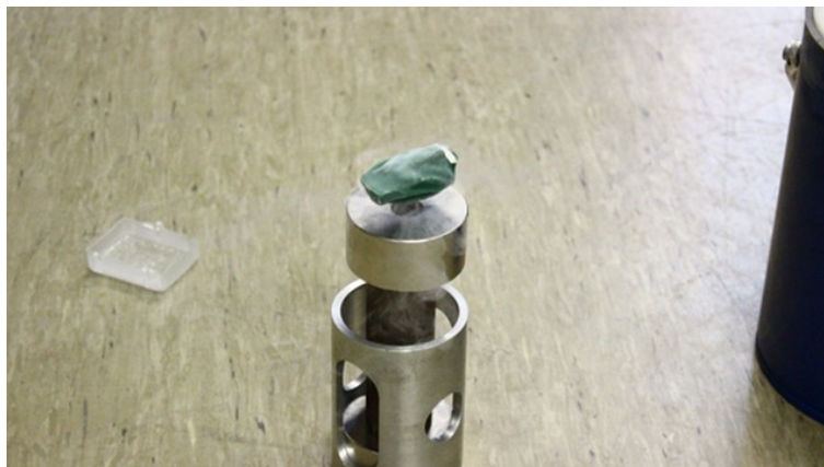
Abb. 3: Supraleiter in aufgeschnittenem Ballon mit Watte als Speicher für flüssigen Stickstoff.
