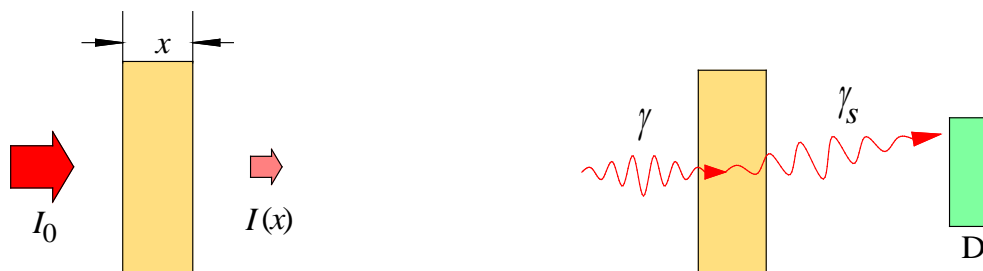
Abb. 5: Links: Zur Abschwächung der Intensität I einer Strahlung beim Durchgang durch einen Absorber (gelb) der Dicke x . Rechts: Beispiel für ein \gamma -Quant, das in einem Absorber unter einem kleinen Winkel COMPTON-gestreut wird. Das gestreute Quant \gamma_s verlässt den Absorber und kann bei kleinem Streuwinkel in einem dahinter stehenden Detektor D nachgewiesen werden.
