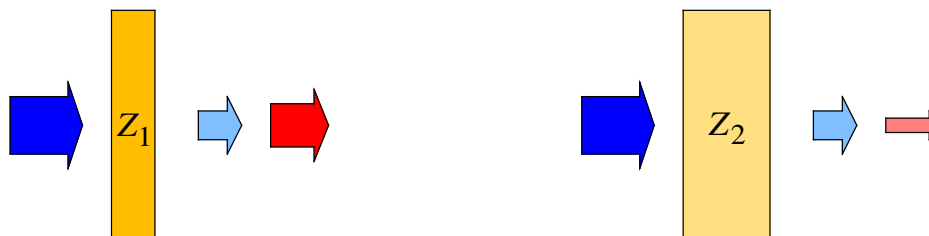
Abb. 13: Auf zwei Platten (gelb) mit gleicher Massenbelegung aber unterschiedlicher Ordnungszahl Z_1 > Z_2 trifft \beta -Strahlung (dunkelblau) gleicher Intensität, die in den Platten gleich stark absorbiert wird. Hinter den Platten herrscht deshalb die gleiche verminderte \beta -Strahlungsintensität (hellblau), aber unterschiedliche Bremsstrahlungsintensität (dunkel- bzw. hellrot).
