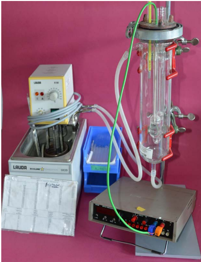
Messung der Temperaturabhängigkeit der Viskosität. Rechts: Ubbelohde-Viskosimeter in Temperiermantel. Links: Wasserbad mit Thermostat und Ausgleichstabelle.
