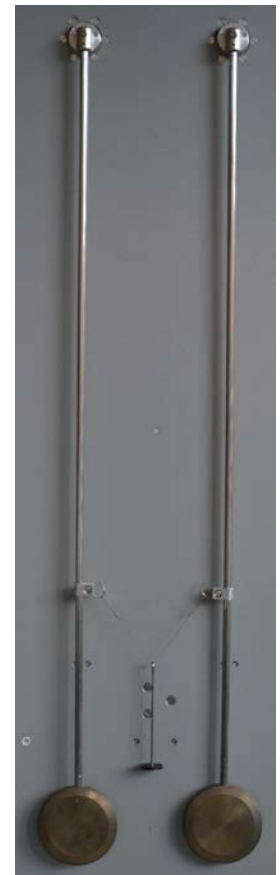
Im Praktikum genutztes gekoppeltes Pendel. Die koppelnde Feder wird durch ein an beiden Pendeln befestigtes Gewicht realisiert.
