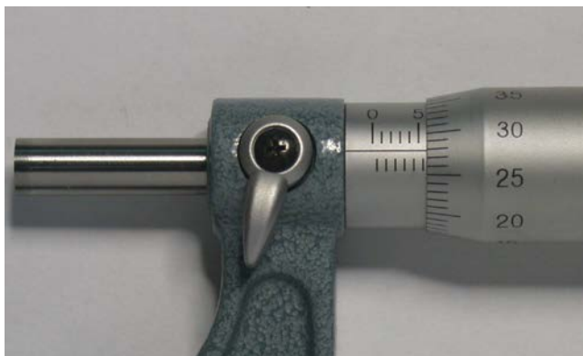
Bügelmessschraube zeigt d = 5,78 \text{ mm}
