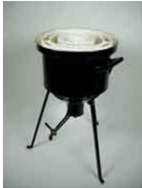
Nachbau eines Eiskalorimeters nach Lavoisier und Laplace
