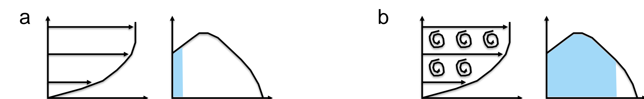
Vergleich der simulierten Strömung (links) und des Turbulenzspektrums (rechts, blau ist simuliert) von RANS (a) und LES (b).
