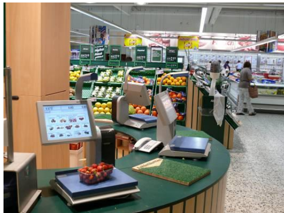
Abb. 1.4: Beispiel einer experimentellen Entwicklung: Die intelligente Gemüsewaage erkennt selbstständig, um welches Obst es sich handelt. Kameras mit einer entsprechenden Auswerteeinheit sind inzwischen Stand der Technik. Die Integration eines solchen Moduls in eine Gemüsewaage ist eine Entwicklungsarbeit. Quelle: Fraunhofer.
