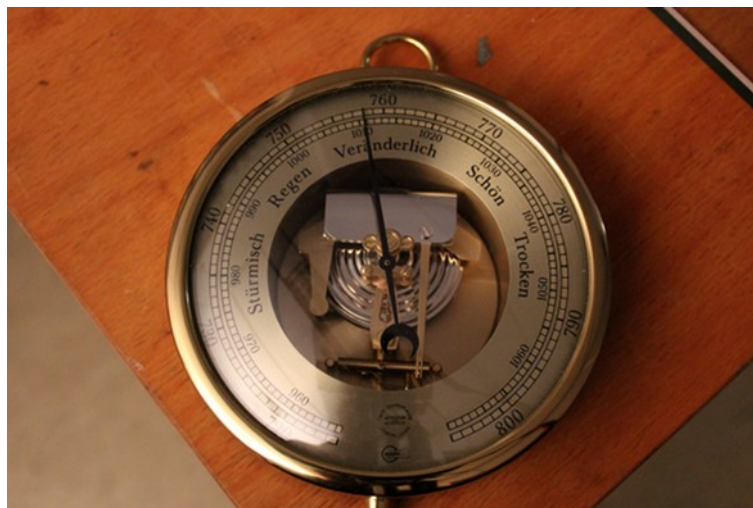
Abb. 4: Barometer aus dem Grundpraktikum, eignet sich ebenfalls um 6 m Höhenunterschied abzulesen, Aufl. ca. 0,5 hPa.
