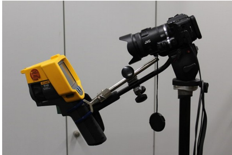
Abb. 1: Wärmebildkamera vor Präsentationskamera montiert
