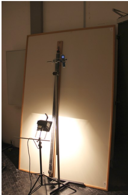
Abb. 4: Bestrahlung einer Heatpipe mit einer Halogenlampe
