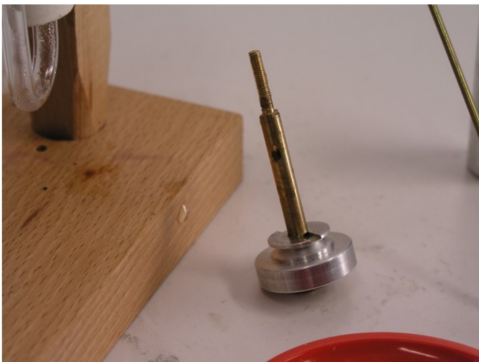
Abb. 4: Das „Steuerventil“ ist bei diesem Modell auf der Achse mit dem Schwungrad montiert. Ein schräg gebohrtes Loch wechselt die Anschlüsse am Kolben von Zu- auf Ableitung.
