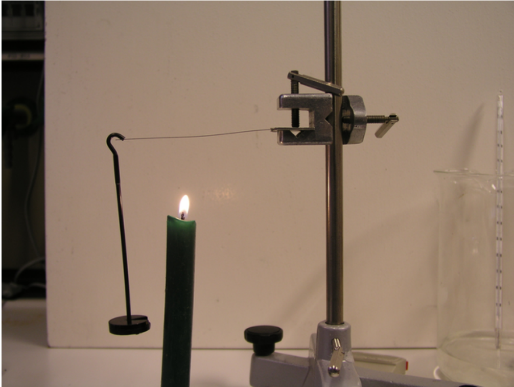
Abb. 1: Ein Gewicht wird von einem dünnen Bimetallstreifen gehalten.
