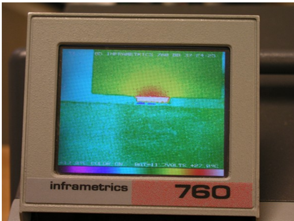
Abb. 3: Falschfarbenbild eines Peltierelements zwischen 2 Metallblöcken
