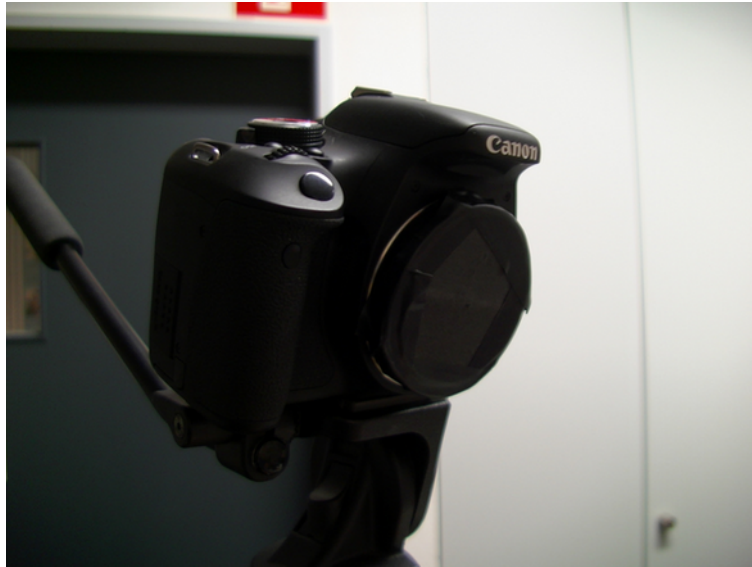
Abb. 1: Spiegelreflexkamera mit Loch als Linse
