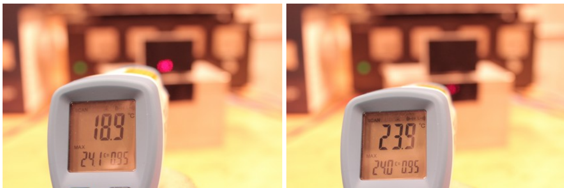
Abb. 4: Temperaturmessung nach längerem Betrieb eines Peltierelement zwischen zwei Aluminiumblöcken.
