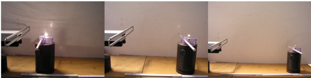
Abb. 2: Abnahme der Intensität mit zunehmendem Abstand.
