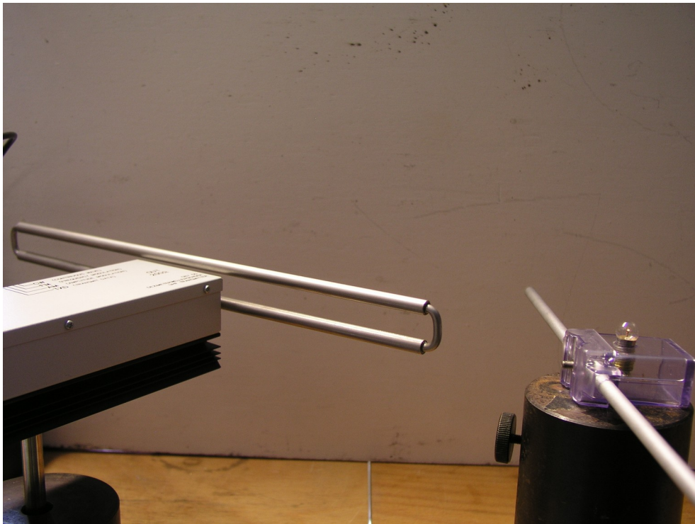
Abb. 3: Intensitätsabnahme in Richtung der Achse des Senders.
