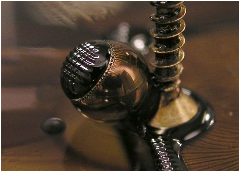
Abb. 1: Magnetisches Fluid im Feld eines starken, kugelförmigen Magneten zieht sich zu symmetrischen Mustern zusammen
