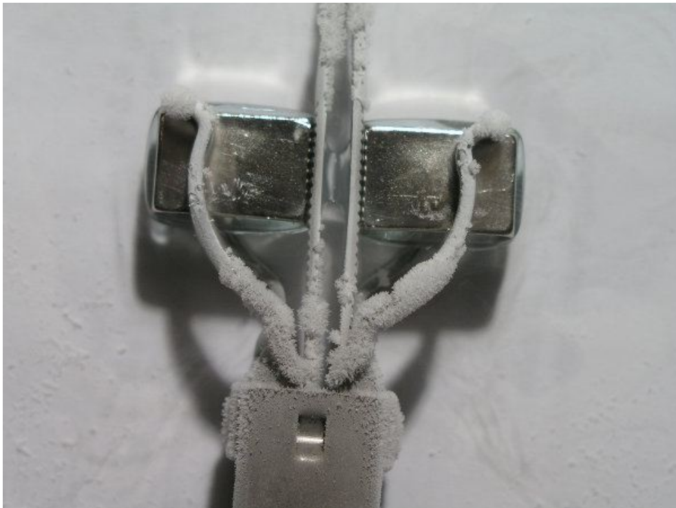
Abb. 2: Flüssiger Sauerstoff (leicht bläulich) wird in Richtung hoher Feldstärken gezogen, er hüllt die Magnete ein und sammelt sich im Spalt dazwischen
