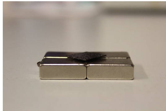
Abb. 7: Ein dünnes Plättchen aus HOPG (highly oriented Pyrolythic graphite) ist relativ stark paramagnetisch und wird in Regionen geringerer Feldstärke gedrängt. Es schwebt auf einer Anordnung mit jeweils gegenpolig gerichteten NeBFe Magneten, in der Mitte ist die Feldstärke am geringsten.
