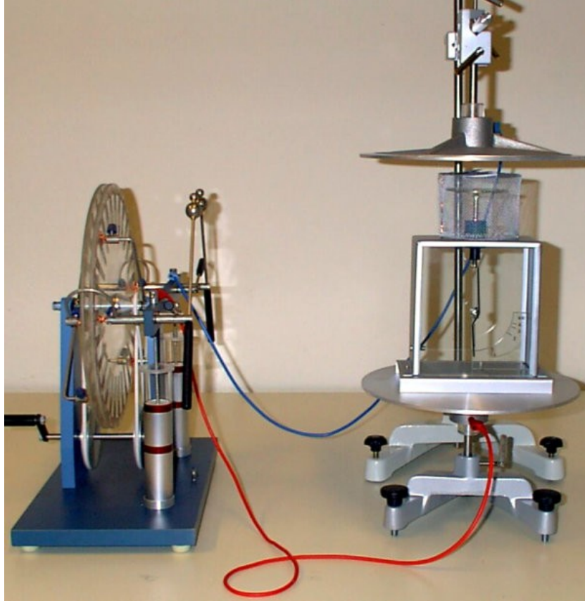
Abb. 1: Elektroskop im Kondensatorfeld
