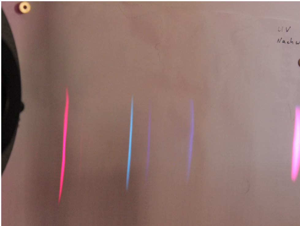
Abb. 4: Wasserstoffspektrum mit einem Reflexionsgitter betrachtet, gebleichtes Papier als Schirm macht auch die H_{\delta} - Linie sichtbar.
