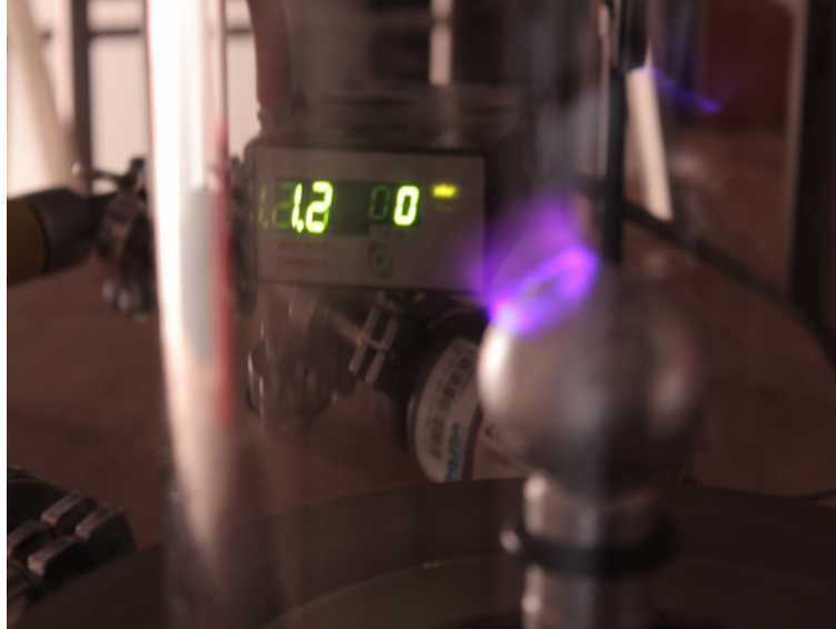
Abb. 1: Leitender Tischtennisball im Vakuumbehälter mit Druckanzeige im Hintergrund.
