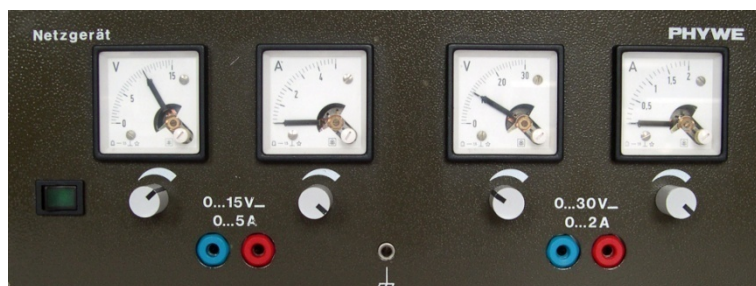
Abb. 1: Netzgerät vom Typ PHYWE. An beiden Ausgängen (jeweils blaue und rote Buchse) ist eine Spannung von ca. 10 V eingestellt.
