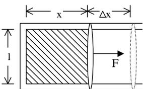
Abb. 3.3: mögliche Anordnung zur Messung der Oberflächenspannung.
