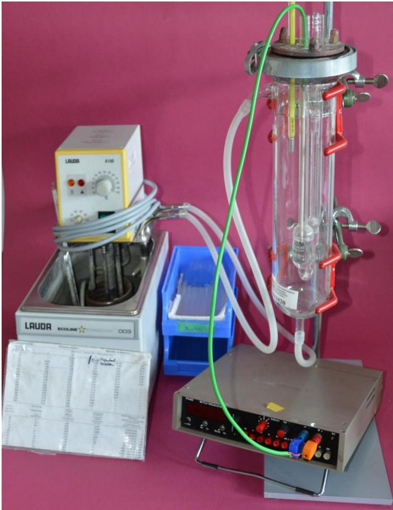
Abbildung 3.1: Messung der Temperaturabhängigkeit der Viskosität. Rechts: Ubbelohde-Viskosimeter im Temperiermantel, links: Wasserbad mit Thermostat und Ausgleichstabelle.
