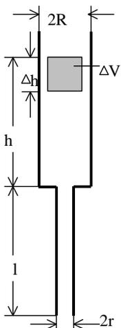
Abb. 3.6: Messung der Volumenstromstärke und der Viskosität
