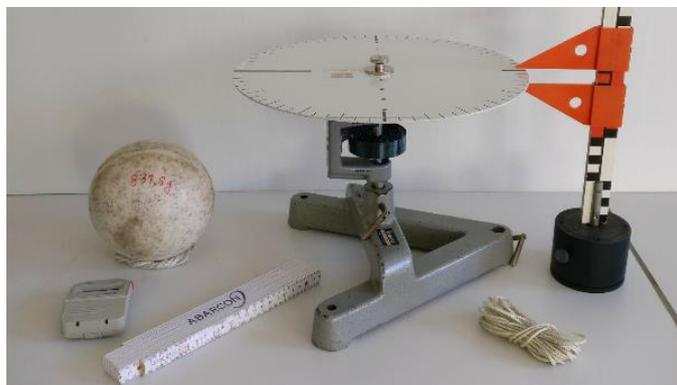
**Abb. 9:** Versuchsaufbau zum Trägheitsmoment.
