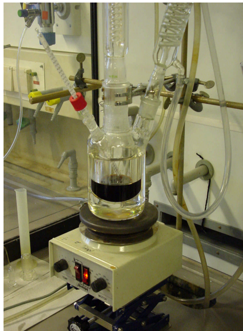
Abbildung 3-2: Photo eines typischen Versuchsaufbaus mit ummanteltem Reaktionsgefäß (rechts vergrößert dargestellt); bräunliche Reaktionslösung im inneren Gefäß, Heizmedium im äußeren Mantel.
