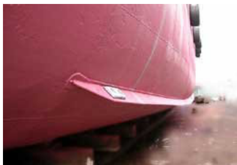
Abbildung 3.4: Abbildung eines Schlingerkiels [126]
