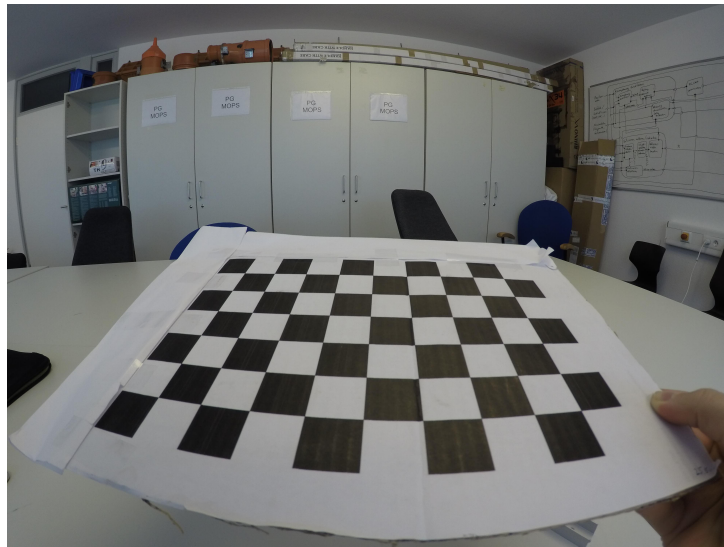
Abbildung 5.7: Beispielaufnahme eines Kalibrierungsobjektes
