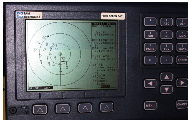
Abbildung A.26: AIS Informationen, dargestellt auf einem ARPA (aus [119])
