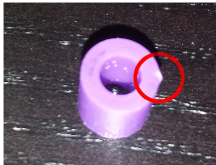
Abbildung 35: Beschädigte Steckperle im Vielfarbenentest
