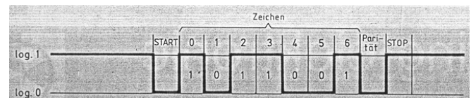
Abbildung 6. Beispiel eines UART Rahmens. Entnommen aus [7]
