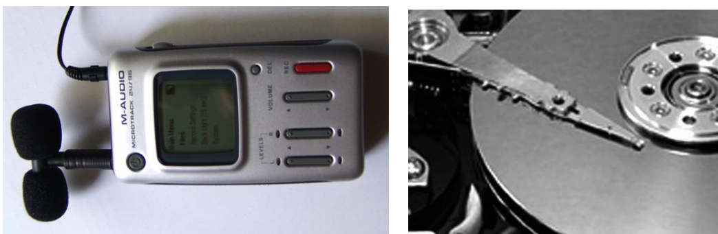
Abb. 4.9 Links der erste Mini- Harddiskrecorder (von Microtrack). Rechts das Innere einer Festplatte, das wie ein Schallplattenspieler aussieht.
