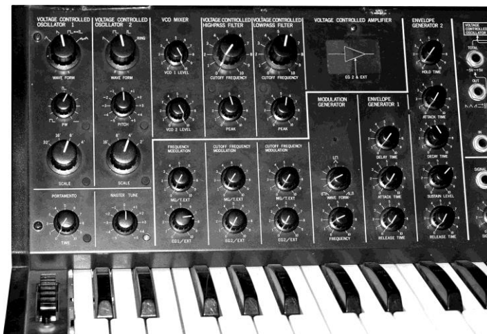
Abb. 10.6 die Module des Analogsynthesizers Korg MS 10 (1978)
