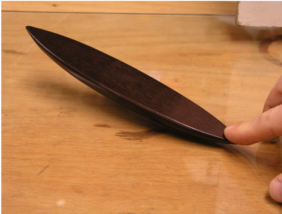
Abb. 4: Keltisches Wackelholz wird zu einer Kippschwingung angeregt
