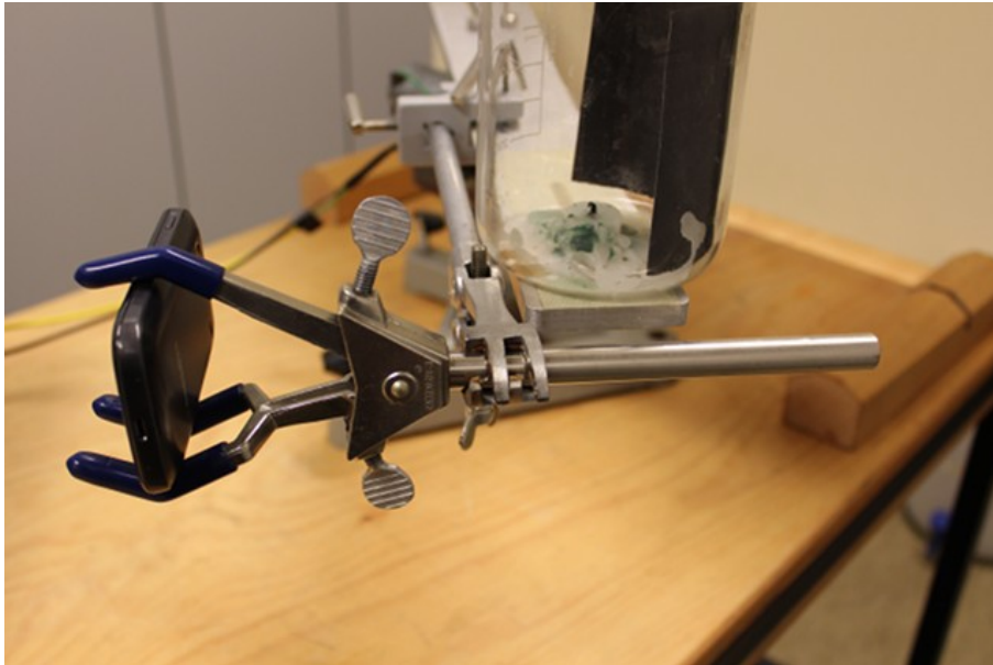
Abb. 3: Detail des Rotationsaufbaus. Kamera eines Smartphones überträgt die Aufnahme, darstellbar innerhalb eines Browserfensters.
