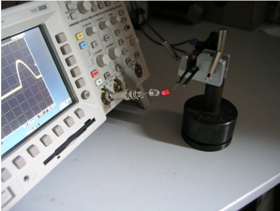
Abb. 3: Eine Leuchtdiode wird mit einer roten LED beleuchtet, auf dem Oszilloskop wird eine Spannung messbar. (Betrieb mit Wechselspannung)
