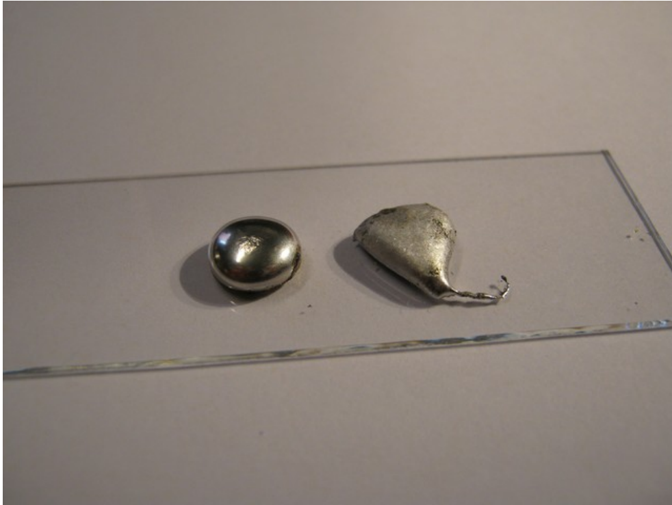
Abb. 1: Erstarrte Mischungen zwischen Blei- und Zinn. Der Bleianteil ist in der rechten Probe vergrößert.
