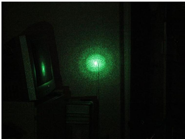
Abb. 2: Zentraler Spot mit 1. Beugungsordnung im abgedunkelten Raum.
