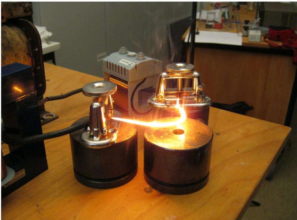
Abb. 5: Der hohe Strom (hier mehr als  $60\text{ A}$  ) bringt Drähte mit Durchmessern  $> 2\text{ mm}$  zum Glühen oder Schmelzen.
