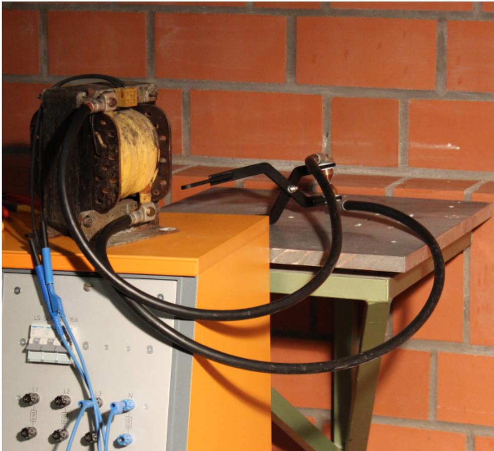
Abb. 6: Mit dieser Vorrichtung können dünne Bleche verschweißt werden.
