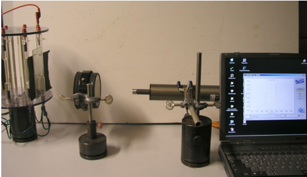
Abb. 1: Versuchsaufbau mit Gasentladungslampen
