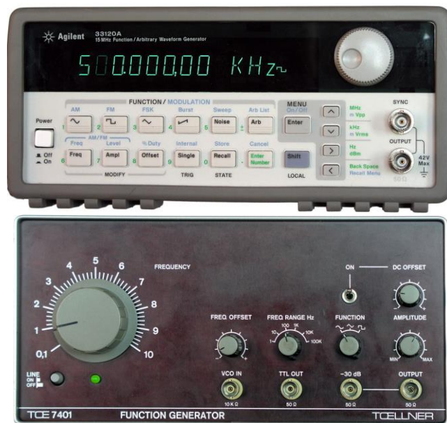
Abb. 4: Frontansichten von zwei im Praktikum eingesetzten Funktionsgeneratoren. Oben : AGILENT 33120A, unten : TOELLNER 7401. Beim FG TOELLNER ist die Frequenz f des Ausgangssignals das Produkt aus dem am Schalter FREQ RANGE eingestellten Wert (hier 100 Hz) und dem am Drehknopf FREQUENCY eingestellten Multiplikator (hier 1). Bei der dargestellten Einstellung ist also f = 1 \times 100 \text{ Hz} = 100 \text{ Hz} .
