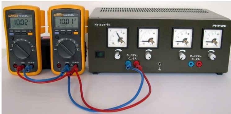
Abb. 2: Zum Vorzeichen der Spannung aus einem Netzgerät. An dessen linkem Ausgang ist eine Spannung von ca. 10 V eingestellt. Das linke Multimeter (Typ FLUKE) zeigt eine Spannung von -10,02 V an, das rechte eine Spannung von +10,01 V 4 . Ursache: der Bezugspunkt für die Spannungsmessung (schwarze Buchse COM am Multimeter) ist links mit der roten Buchse des Netzgerätes verbunden (an der das höhere Potential liegt), rechts mit der blauen Buchse (an der das niedrigere Potential liegt).
