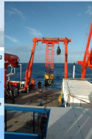
Ausbringen von schwerem Gerät mit dem A-Rahmen von Bord "Maria S. Merian". [Fotos: Briese Schifffahrts GmbH & Co. KG]
