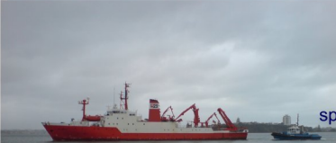
FS Sonne vor Auckland, Neuseeland. (Bildquelle: Wikipedia, Public Domain) Gebaut 1968 als kommerzieller Heckkranter, also als Fischereischiff, wurde die Sonne 1978/79 zum Forschungsschiff umgebaut. Die Bundesregierung benötigte dringend ein Schiff zur meereswissenschaftlichen Rohstoffforschung. Ein weiterer Umbau und eine Modernisierung schlossen sich 1991 an.
