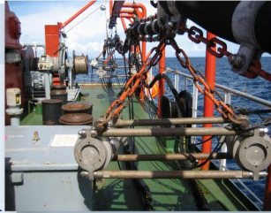
Luftpulser ("Air Gun"), hier vor dem Einsatz von Bord des FS "Sonne", werden zur Erforschung der Erdkruste eingesetzt. [Foto: © BGR Hannover]
