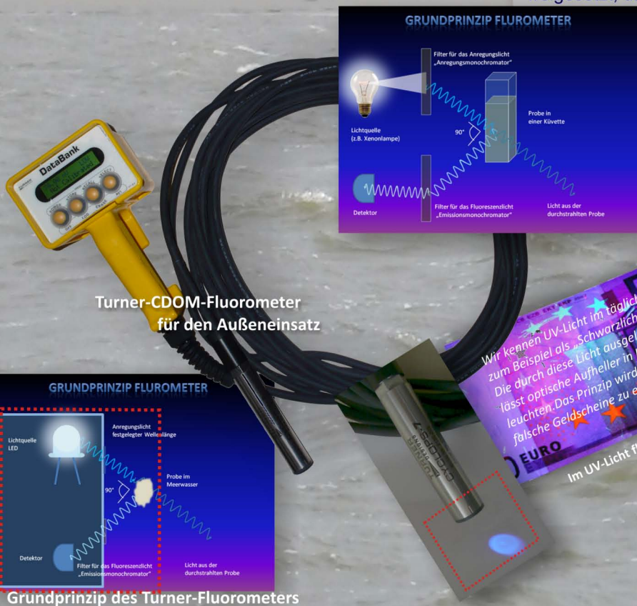
Grundprinzip des Turner-Fluorometers
