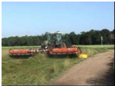
Mahd mit Kreismähwerk (Mittelschwad- ablage)
