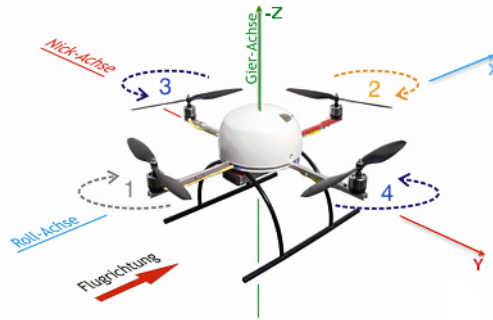
Abbildung 3.4: Definition Koordinatensystem gemäß MPU 9051 [Teb]
