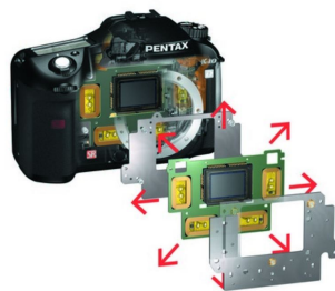
Abbildung 3.25: Funktionsweise der mechanischen Bildstabilisation in einer Kamera [Gro]
