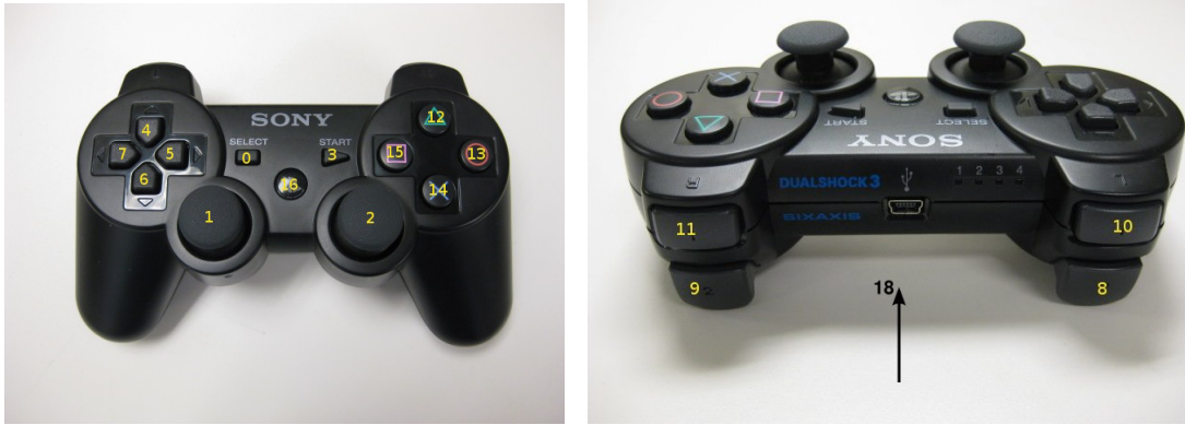
(a) 0-reset, 1-Steuerhebel, 3-starten/stop, 12-E-Stop, (b) 8-Karten speichern, 9-Mähmotor an, 10-Karten anlegen, 11-Mähen 14-Position speichern, 16-Koppeln
