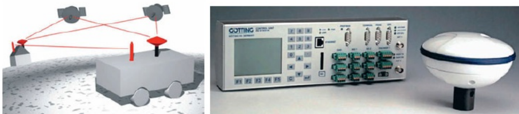
Abbildung 4: Prinzipskizze zur Koppelnavigation (links) und zur Magnet- bzw. Transpondernavigation (rechts) (Quelle: Günter Ullrich, 2011 S. 79)
